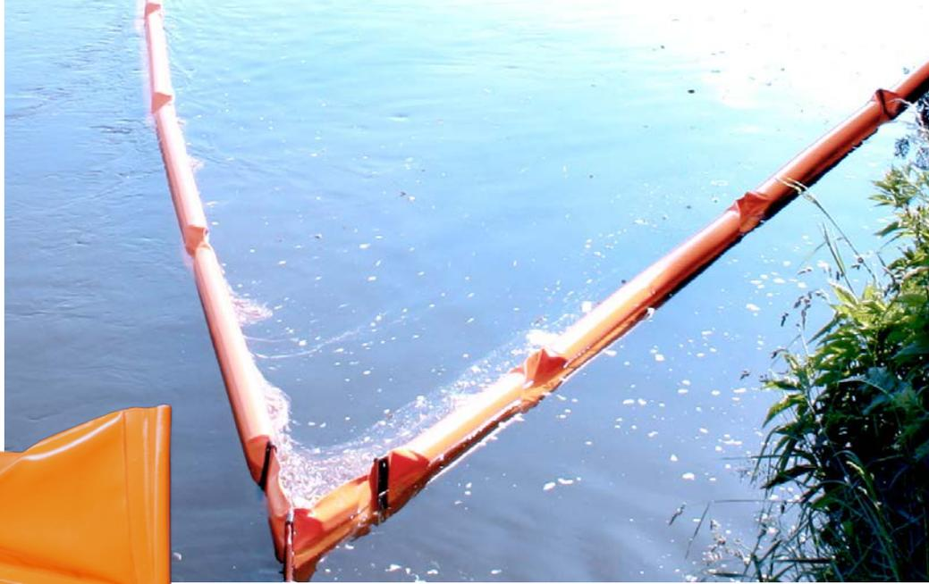
Diese Ölsperre ist eine flexible Festkörpersperre, bestens geeignet für ruhige Gewässer oder permanent eingebaute Absicherungen. Die 80 cm breiten Auftriebskörper aus festem Polyurethan-Hartschaum in Segmentbauweise sind dicht in der Ölsperrenhülle eingeschweißt. Im Saum der Schürze sind Gewichte als Ballastausgleich zur Konterstabilisierung ein-konfektioniert.
