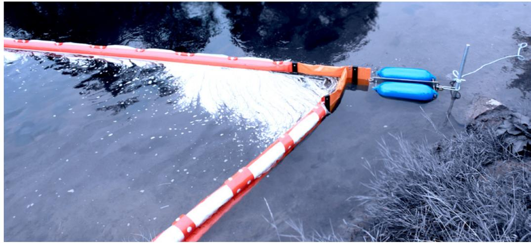
Die Kombi-Ölsperre ACS – „Absorber Combi Schürzensperre“ lässt sich aktiv als auch passiv einsetzen und bietet somit eine praxisorientierte Kombination aus herkömmlichen Absorber-Schlauchsperren und Tauchwandsperrern.
