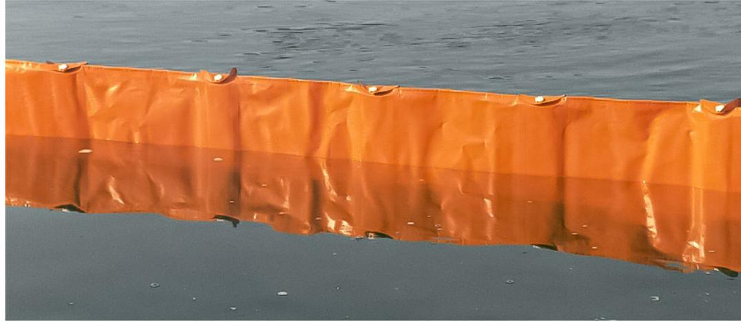
Die Tauchwandsperrre 300/400 F oder 200/250 F eignet sich hervorragend sowohl für den schnellen Ölwehreinsatz, als auch für die stationäre Anwendung, vorzugsweise in ruhigem Gewässer. Die Sperre besteht aus einer durchgehenden, halbtauchenden Wand aus HD Polyester-gewebe mit Vinylbeschichtung.
